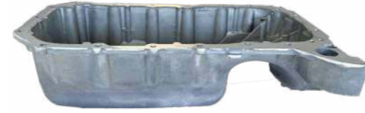
کارتر TU5 Peugeot TU5 engine oil sump (Carter) کارتر TU5 ( محفظه وقود تحت المحرك )
