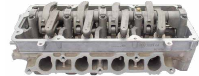
سرسيلندر كامل تيبا يورو 2 Saipa Tiba (Euro 2) assembled cylinder head kit رأس الاسطوانة المجهزة طيبه يورو 2
